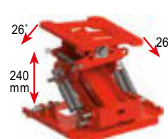
Höhenausgleich H 240 P / Parallelogramm 240 mm, Pendel links/rechts 26° (max. Gewicht Mulchkopf 300 kg) (Art.-Nr.267.95.163) 1.080 €
