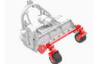
2 x ausgeschäumte Gummi- Räder 360 ° abdrehbar, kugellagert (270 mm Ø, 185 mm Breite) mit Halter, anstatt Laufwalze. (Nur bei Heckanbau möglich)
